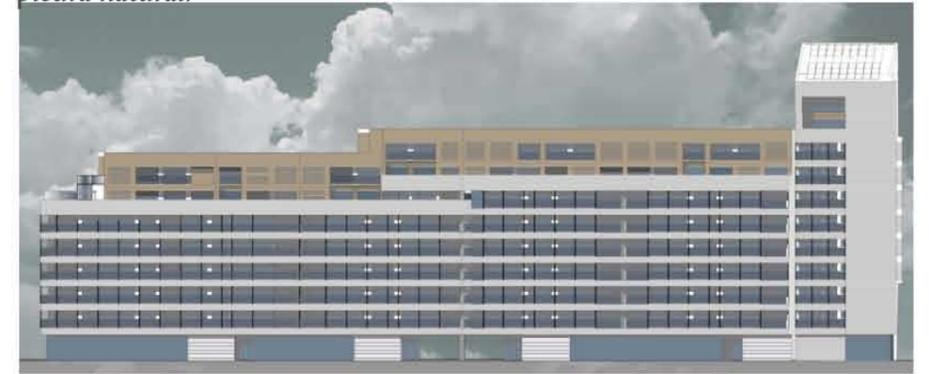
**Edificio Este:** Fachada ventilada de aplacado de piedra natural, con carpintería exterior de aluminio lacado (con rotura de puente térmico) y persianas enrollables de aluminio con aislamiento interior.
